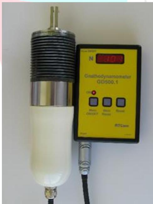
**Fig. 1 Gnatodynamometer GD500.1**
